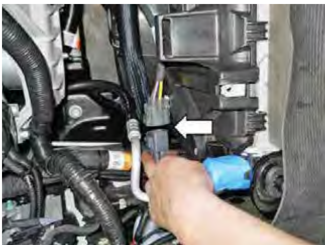
Fan electrical connector
